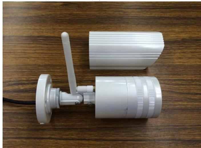
2. 左手で本体の固定した状態で先端のカメラレンズカバーを内側に回して、レンズカバーを外します。
