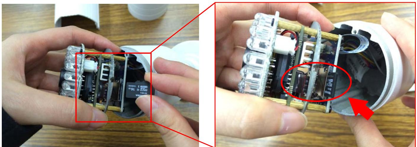
6. micro SDカードを差し込んだら、逆の手順で防犯カメラを組み直せば、これで取付作業が完了です。
