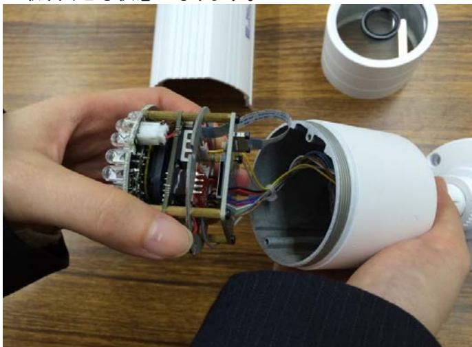
5. 基盤の後ろの鉄板の裏にmicro SDカードの挿入口があります。
