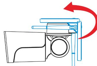
④回転させたら①で緩めたネジをしっかりと締め直してください。
